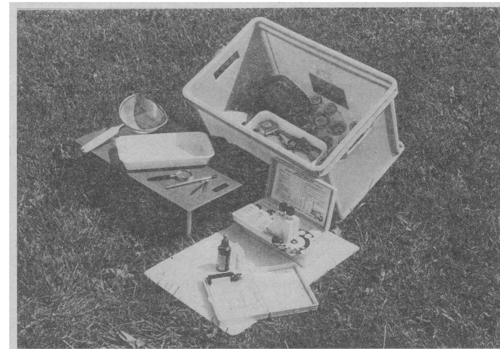
Abb.9: Kunststoffcontainer mit Platz für alle notwendigen Geräte und Testbestecke, Zwischenboden und Deckel können im Gelände als Tische verwendet werden.
